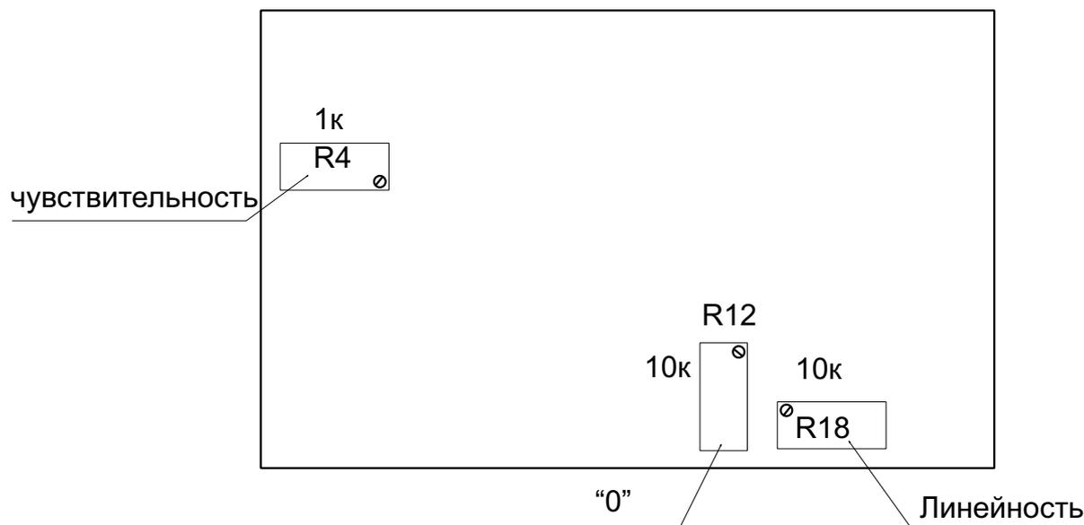
4. Установить начальный зазор между датчиком и контрольной поверхностью равным 0 мм. Регулятором «ноль» установить значение, соответствующее левому краю шкалы прибора (0В на выходе преобразователя).
